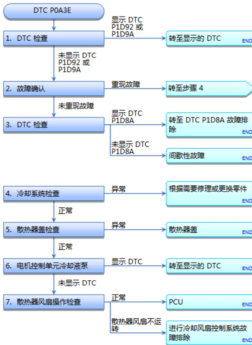
**DTC P0A3E: 发电机电机逆变器过热**注意: 进行故障排除前, [查看一般故障排除信息](#)。
